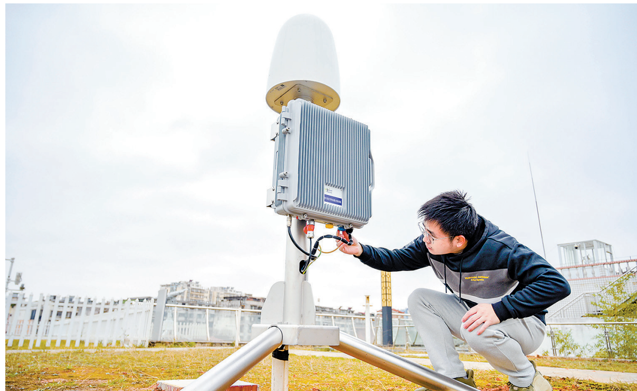
近日,赣县区成功建成赣州首个北斗探空系统接收站。据悉,北斗探空系统作为最新一代的高空气象资料探测系统,具有定位精准、信号强度高、覆盖范围广等优点,且具备平漂探空能力,实现一次放球就能获取上升、平漂、下降三个阶段共计约6小时的高空连续观测数据。图为赣县区气象局的工作人员在调试北斗探空系统接收机。
