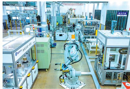
在菲仕绿能科技(赣州)有限公司智能化生产线上,工业机器人正在装配永磁电机。
