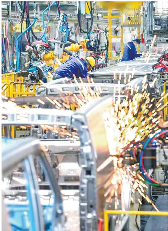
山东凯马汽车制造有限公司赣州分公司生产车间,工人正在焊接安装汽车整车车架。
